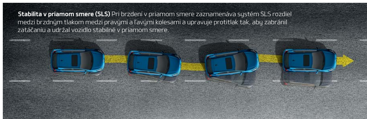
Elektronický stabilizačný systém (ESC) V prípade náhleho brzdenia alebo otáčania systém ESC aktivuje reguláciu krútiaceho momentu a nezávislé rozdeľovanie brzdnej sily, čím vás bezpečne spomalí a zaisť maximálnu kontrolu.
