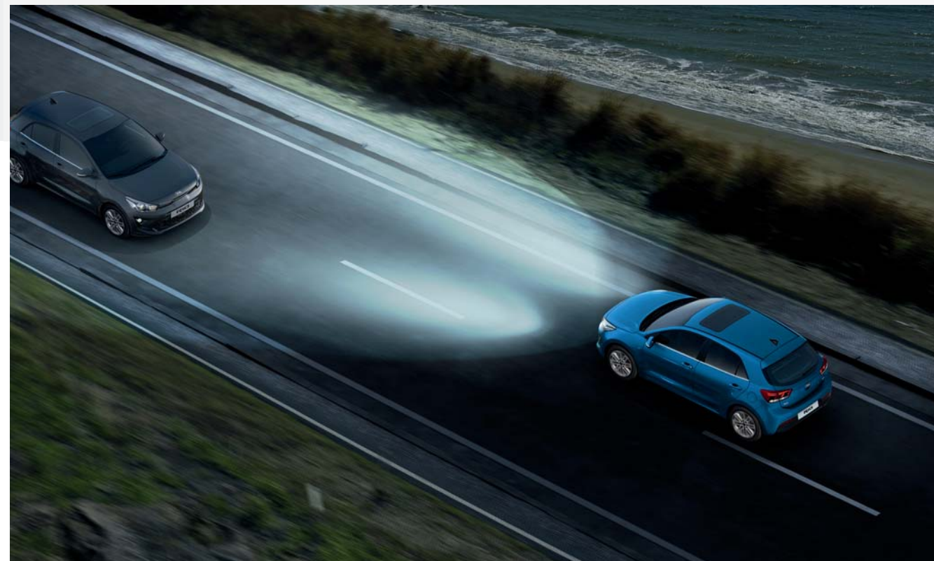
Asistent diaľkových svetiel Kamery zabudované v čelnom skle rozpoznávajú prichádzajúce vozidlá v noci a automaticky prepínajú svetlá na stretávacie, aby zabránili oslneniu ostatných vodičov. Len čo protiidúce vozidlo prejde, diaľkové svetlá sa znovu zapnú.
