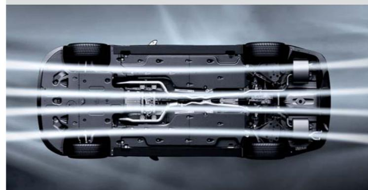
**Početné spodné kryty a aerodynamické efekty** Kým aerodynamické aspekty siluety sú zreteľne viditeľné, Kia Stinger sa môže popýšiť aj prvkami znižujúcimi odpor vzduchu, ktoré zlepšujú prúdenie vzduchu pod vozidlom. Vozidlo využíva systém odolných spodných krytov, ktoré sa nachádzajú pod motorom, prevodovkou, po každej strane kabíny a po každej strane zadného odpruženia. Tieto kryty znižujú prietokový odpor vzduchu v spodnej časti karosérie, keď vozidlo ide vyššou rýchlosťou.
