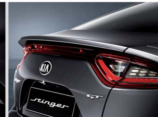
**Veko batožinového priestoru s efektom spojlera** Na účely zlepšenia stability a optimalizácie prúdenia vzduchu, ktoré sa vytvára za modelom Stinger pri jazde vysokou rýchlosťou, má koncový profil veka batožinového priestoru oblúkový tvar, pričom poskytuje efekt spojlera – a zároveň úchvatné zakončenie siluety modelu Kia Stinger.
