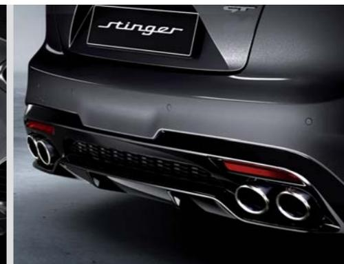
**Zabudovaný zadný difúzor** Zabudovaný panel difúzora pod zadným nárazníkom pomáha regulovať prúdenie vzduchu a zabraňuje vytváraniu aerodynamického odporu dvojitými koncovkami výfuku. Vzdáva počtu pretekárskym difúzorom určeným na znižovanie turbulencií, ktoré sa môžu vyskytnúť, keď sa vzduch s nízkym tlakom – nachádzajúci sa pod vozidlom – stretne s okolitým vzduchom s vyšším tlakom.
