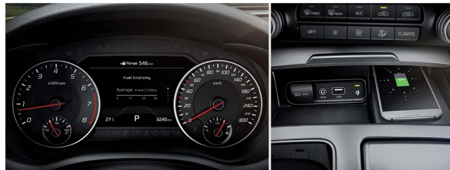
**Združený prístroj Supervision so 7-palcovým displejom** 7-palcový displej TFT LCD s vysokým rozlíšením, ktorý sa nachádza na združenom prístroji Supervision, poskytuje základné informácie – od priemernej spotreby paliva až po postupné navigačné informácie, pričom ponúka možnosť ich prispôbenia.
