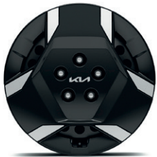
16-palcové oceľové disky kolies s okrasnými plastovými krytmi (pneumatiky 205/65 R16) Light
