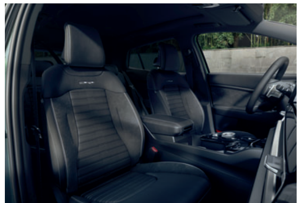
Čalúnenie sedadiel v kombinácii umelá koža (sedák) / alcantara (boky) / GT-line + Premium pack
