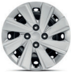
15-palcové oceleové disky kolies s okrasnými plastovými krytmi (pneumatiky 185/65 R15) Silver / Silver+
